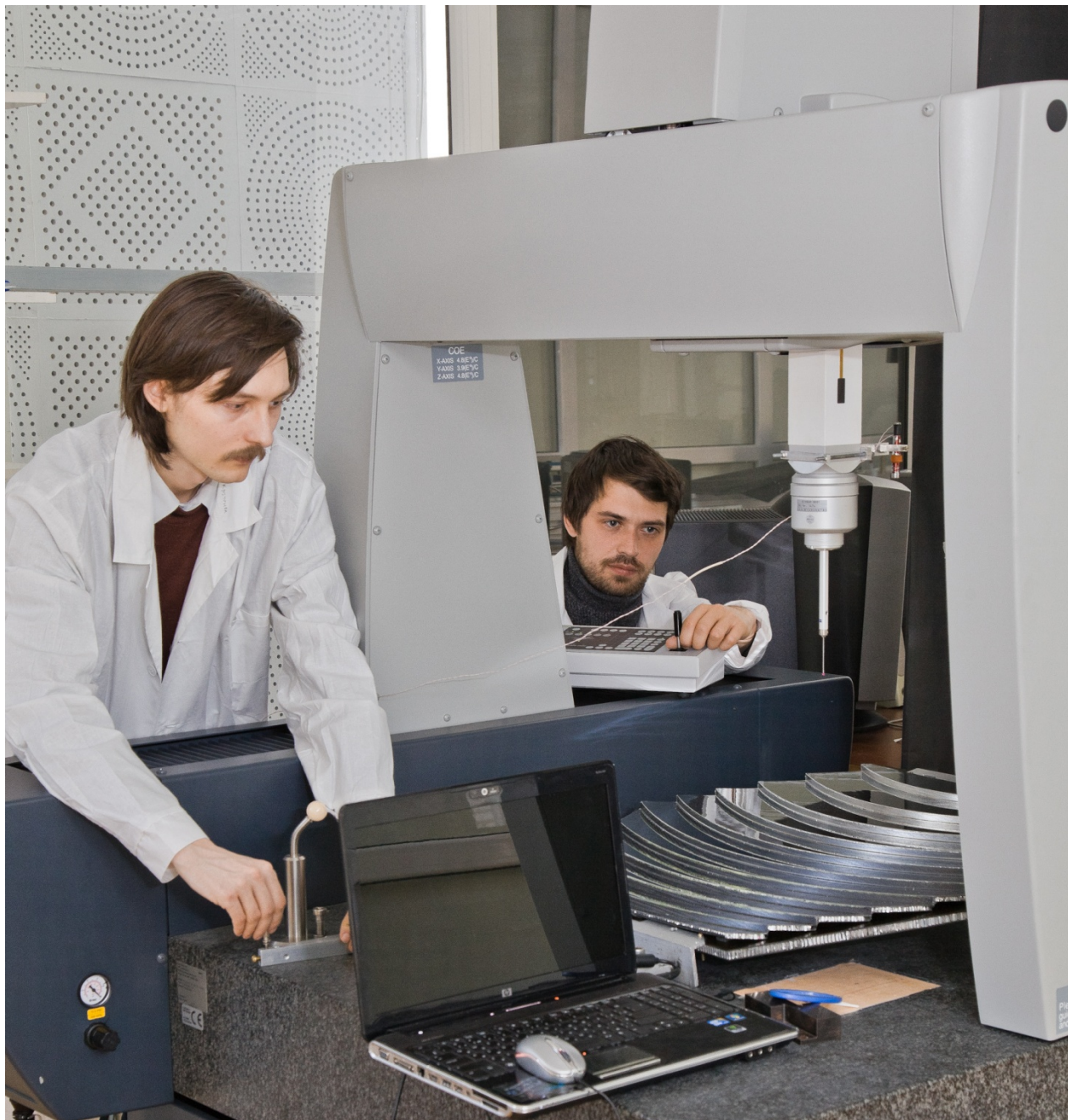
Измерение оптических параметров зеркала ТУС
